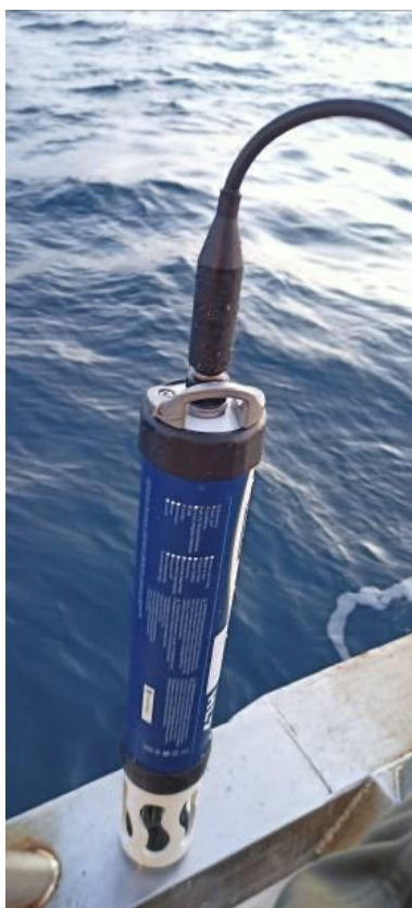
Foto 9.1: Sonda multiparametrica Hydrolab HL7 utilizzata per le analisi della colonna d'acqua.
