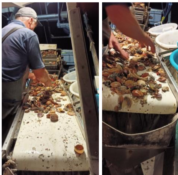
Foto 10.2: Nastro per la selezione manuale degli esemplari di C. chione .
