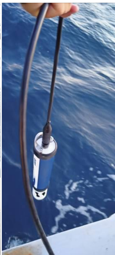
Foto 9.1: Sonda multiparametrica Hydrolab HL7 utilizzata per le analisi della colonna d'acqua.
