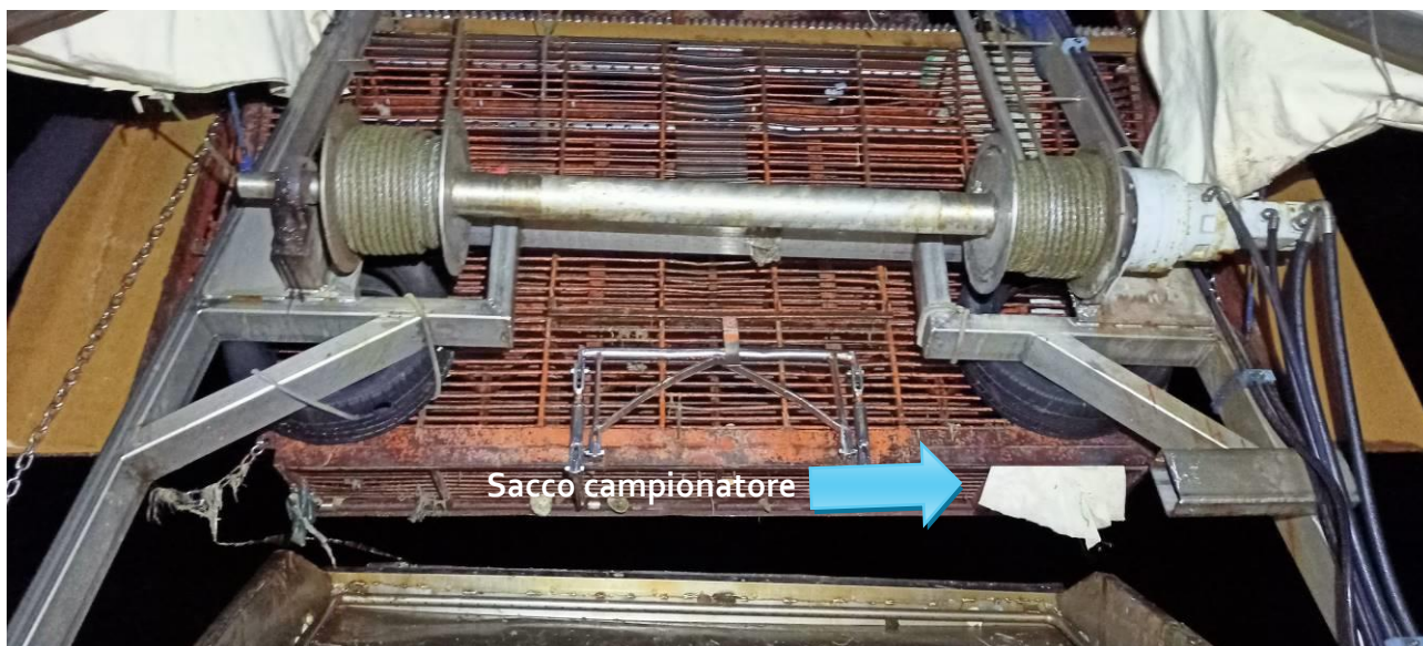
Foto 10.1: Sacco campionatore posizionato all'interno della draga per la raccolta del bentos e degli esemplari di C. chione .
